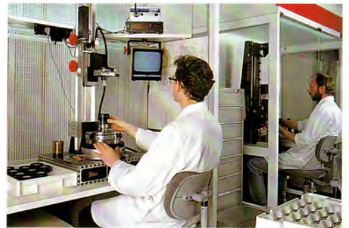
Preciso controllo della centratura degli obiettivi con un interferometro al laser.
