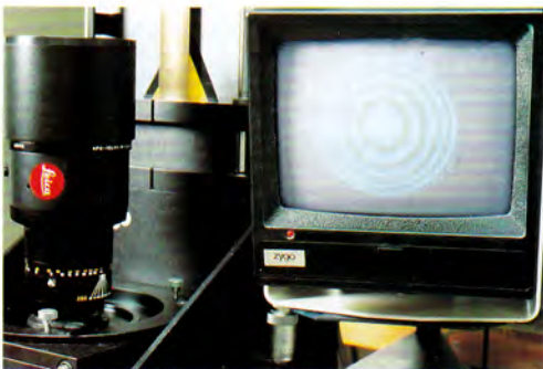
Un'assoluta precisione meccanica ed ottica è il risultato di una centratura perfetta e del corretto posizionamento di tutti gli elementi dell'obiettivo, gli uni rispetto agli altri.
